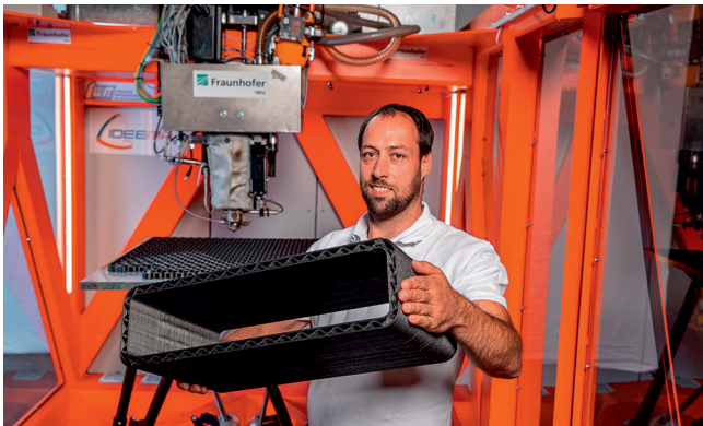
Bild 1. Maschine SEAM-Hex mit extrusionsbasierter Plastifiziereinheit und einer Hexapod-6-Achs-Parallelkinematik (© Fraunhofer IWU, Dirk Hanus)
