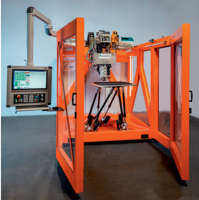
Bild 2. Maschine PentaSEAM mit Metrom-5-Achs-Parallelkinematik und Extruderwerkzeug (© Metrom)
